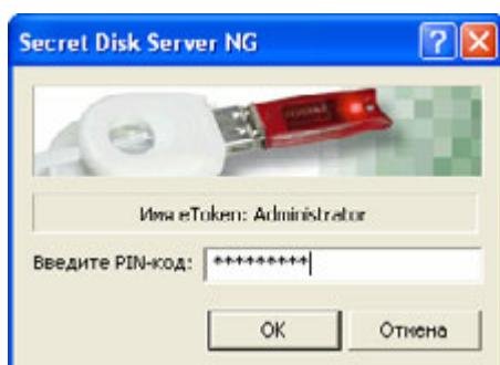
При необходимости подключите eToken, следуйте инструкциям датчика случайных чисел, выбирайте считыватель (eToken) и вводите PIN-код (интерфейс зависит от поставщика криптографии).
