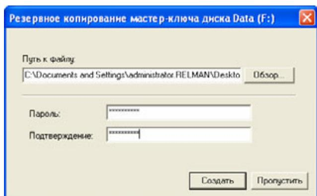
Система сгенерирует мастер-ключ защищённого диска. Для того чтобы сохранить резервную копию этого криптографического ключа, укажите путь к файлу резервной копии и введите пароль дважды — в графу **Пароль** и в графу **Подтверждение**. Нажмите **Создать**.
